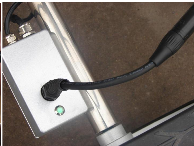
Connexion électrique batterie avec contrôleur
