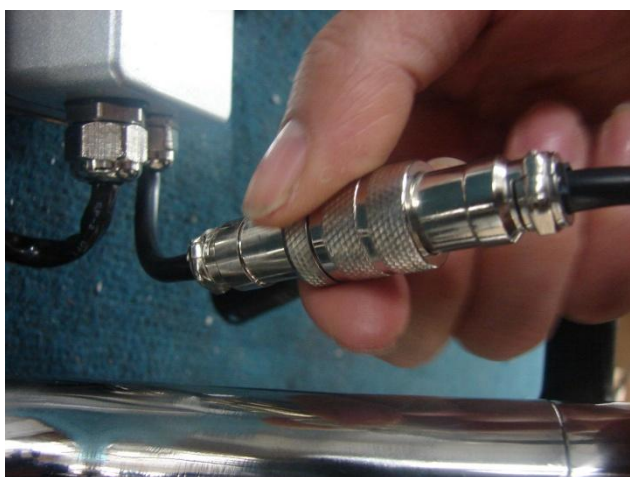
Connexion électrique manche sur contrôleur
